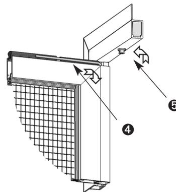
Den Abstand des Drehrahmens zum Montagerahmen prüfen, ob dieser rundum gleich ist (6 mm), bei Bedarf die Position des Montagerahmens korrigieren.
