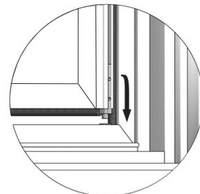
❶ Drehrahmen wie abgebildet mit dem unteren Drehbeschlag in das Aufnahmeteil stecken, ❷ zum Mittelband ausrichten, Schiebeklemmteil mit dem mitgelieferten Inbusschlüssel in das Mittelband schieben und anziehen. ❸ Oberen Drehbeschlag mit dem mitgelieferten Inbusschlüssel auf Anschlag in Buchse einschieben und fest anziehen.
