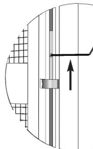
Drehrahmen nach vorne kippen und herausheben. Bürstendichtungen aus dem Montagerahmen entfernen.
