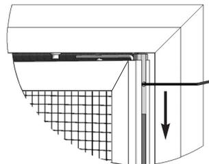
Mit dem mitgelieferten Inbusschlüssel oberes und mittleres Drehband lösen und aus Buchse bzw. Öse schieben.
