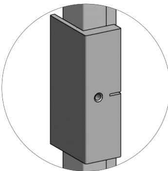
Bohrlehre P16 40 10 nach den angegebenen Maßen positionieren. Mit Bohrer ø 4,5 mm die Führungsschienen von Vorne durchbohren. Danach mit dem Kegelsenker die erste Profilwand durchsenken.
