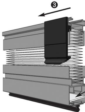
Plisseeverschlussteil in dem Profil ohne Bürste von oben einschieben **3**, bis zur Mitte fahren und Plisseekit schließen. Die Schnur mit Schnurumlenkung und Schnurspanner mithilfe des Kartonstreifens **4** aus dem Plisseekit herausziehen.
