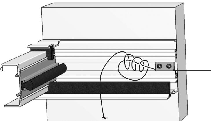
Die Schnur mit dem Schnurspanner wie bei Schritt 3 Punkt 8 beschrieben, leicht spannen und Gewindestifte anziehen.
