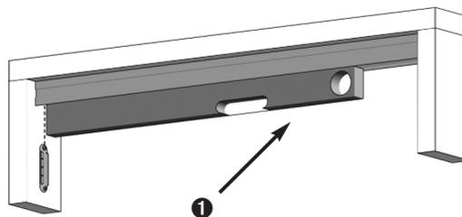
Kastenprofil waagrecht in der Leibung ausrichten ①. Bohrpositionen durch die Montagebohrungen ② anzeichnen, mit Steinbohrer  $\varnothing$  6 mm vorbohren. Mitgelieferte Dübel setzen und mit Schrauben RK 3,9 x 38 anschrauben.
