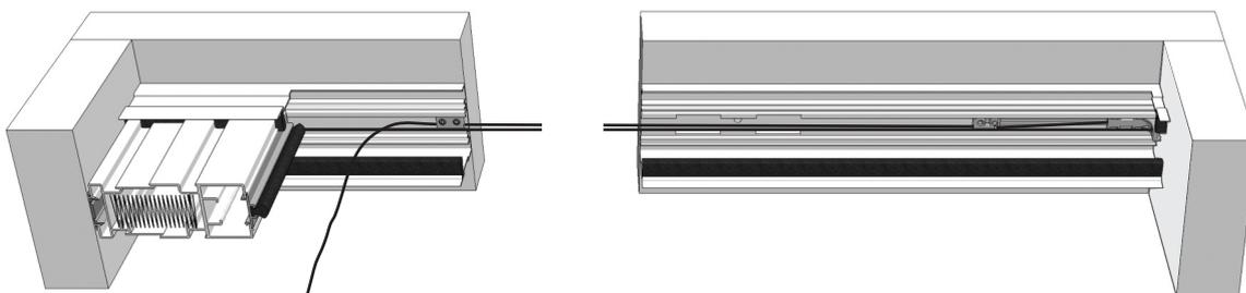
Schnur vor dem Schnurspanner mit 3-fach Schlingknoten verknoten und fest anziehen. Den Rest der Schnur anschließend ca. 3 cm nach dem Knoten abschneiden.
