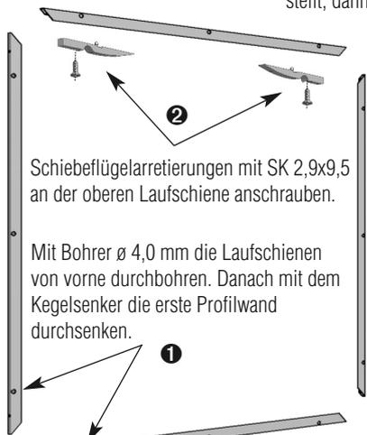
Schiebeflügelarretierungen mit SK 2,9x9,5 an der oberen Laufschiene anschrauben.
