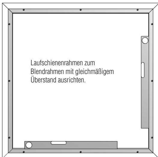
Durch die Montagebohrungen vorbohren und mit RK 3,5x13 anschrauben. Abdeckkappen aufstecken.
