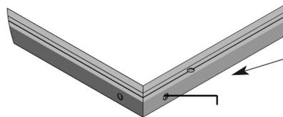
Mit dem Inbusschlüssel abwechselnd links und rechts verklemmen.
