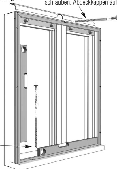
4 Schiebeflügel einhängen (siehe 4) und schließen. Stulpprofil zum Schiebeflügel ausrichten und Außenkante markieren.
