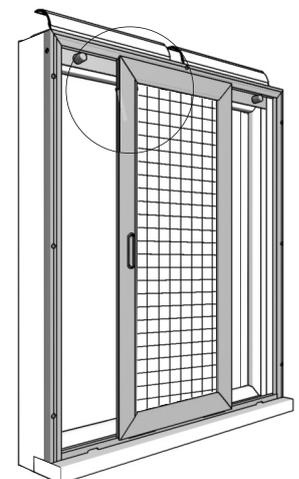
Auf der Gegenseite kann die Schiebeflügelführung (Unterteil) komplett hochgeschoben werden (Feder auf Block). Dadurch kann der Effekt der Aushägesicherung erzielt werden und gleichzeitig bei sehr schmalen Flügeln ein Kippen verringert werden.
