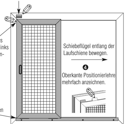
Schiebeflügel entlang der Laufschiene bewegen.
