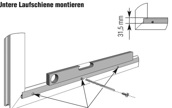
Durch die Montagebohrungen vorbohren und mit RK 3,5x13 anschrauben.
