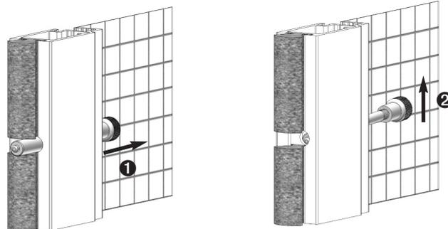
Schieberahmen zur Maßkontrolle in der Leibung in Einbauposition stellen und Position der Auflagerundteile festlegen und markieren.
