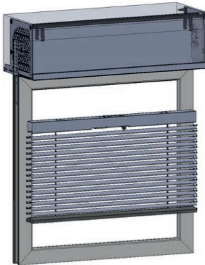
Grundschiene bezogen auf die Bemaßung ausrichten und befestigen.
