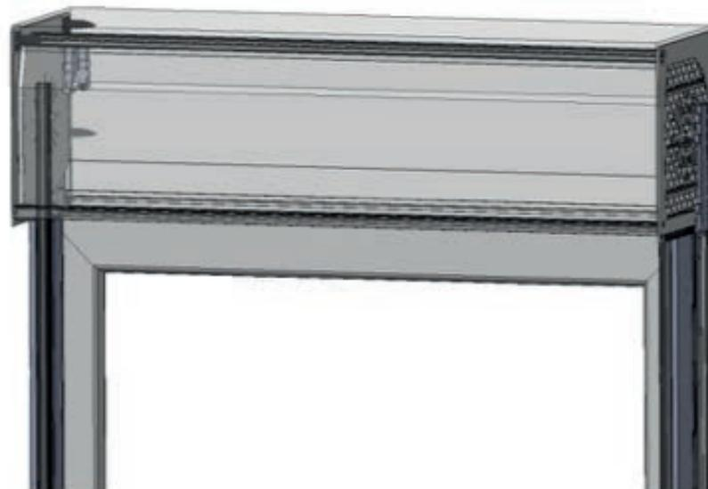
Generell: Die Führungsschienen Typ N18 werden ohne Unterlagen auf das Grundprofil geschraubt.
