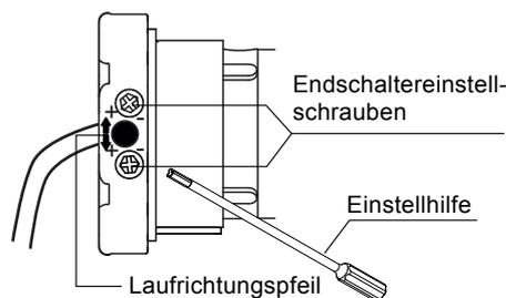
2. Drehen Sie mit der Einstellhilfe die Endschaltereinstellschraube **AB** in + oder – Richtung bis Sie die endgültige Endlage erreichen. Eine Umdrehung der Endschaltereinstellschraube entspricht ca. 60° Wickelwellenumdrehung.
