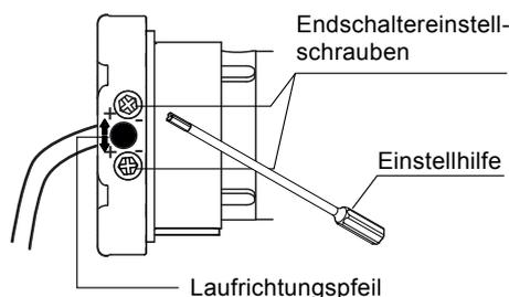
4. Drehen Sie mit der Einstellhilfe die Endschaltereinstellschraube **AUF** in + oder – Richtung bis Sie die endgültige Endlage erreichen. Eine Umdrehung der Endschaltereinstellschraube entspricht ca. 60° der Wickelwellenumdrehung.
