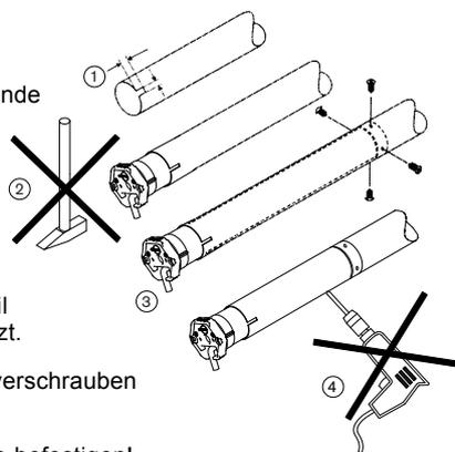
Sichern Sie das Gegenlager gegen axiale Verschiebung, indem Sie den Achsträger vernieten oder verschrauben.
